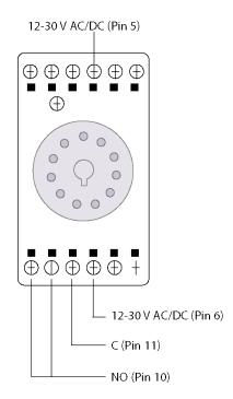
VOLTAGE CONNECTION T20/T60RX-03ASL T20/T60RX-03ASM
